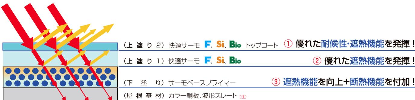
(注) 波形スレートに施工する場合は、あらかじめシーラー塗装が必要です。 (波形スレート) 快適サーモマイルドシーラー白 (ノンアスベスト波形スレート) 1液ノンアス用シーラー
